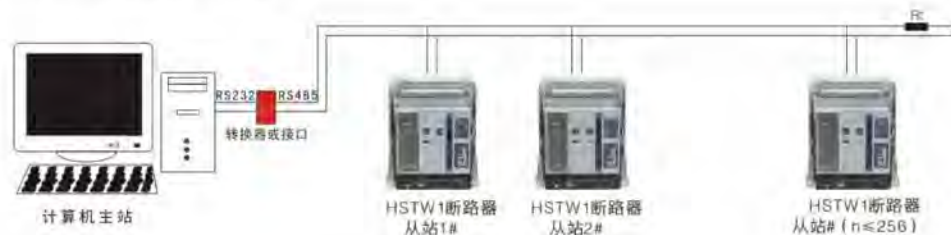
Mod bus 协议通讯连接示意图
