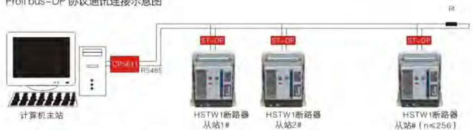
Profi bus-DP 协议通讯连接示意图
